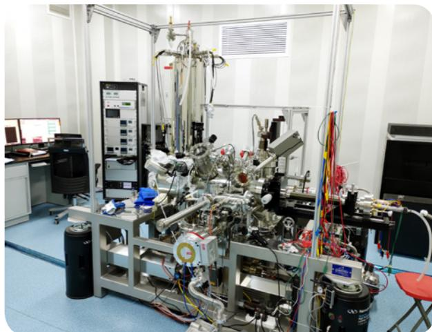
②一台高能电子反射衍射仪, 衍射电子能量范围是  $10\text{ keV} \sim 20\text{ keV}$ , 可监测样品表面结构, 并且可看到清晰的衍射斑纹或斑点;
